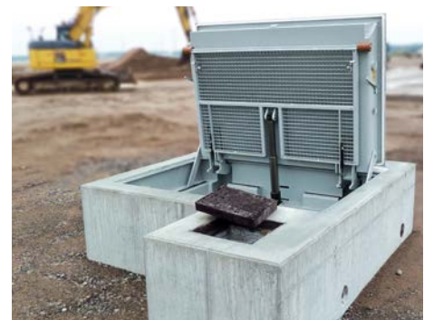
Hydraulisch betätigte Schwerlastabdeckung als Stahlbetonfertigteile, Klasse F 900, Frankfurt
