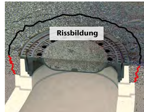
Durch Schwingungen erzeugte Risse an herkömmlichen Schachtabdeckungen
