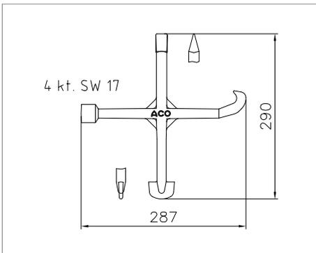
**Aushebe- und Bedienungsschlüssel
