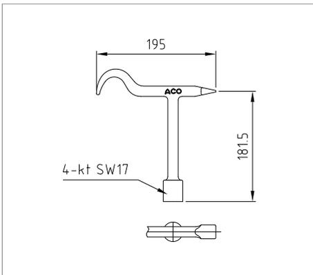
**Aushebe- und Bedienungsschlüssel**
