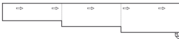
Stufengefälle (Rinnenkörper mit unterschiedlichen Bauhöhen)
