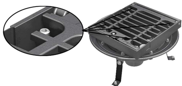
Höheneinstellung und Ausrichtung mittels 4 Stellschrauben im Oberteil (Einstellbar bei geschlossenem Rost). Innensechskant 8 mm
