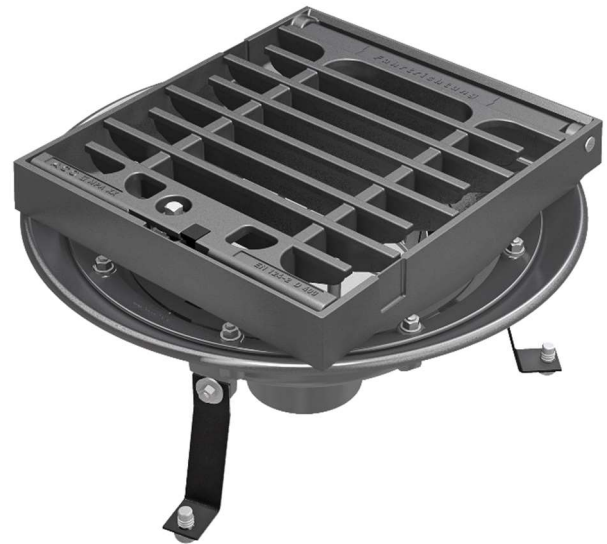
Brückenablauf Multitop Aqua Plus HSD-2, Klasse D 400, Abgang senkrecht, mit Flanschring verschraubt
