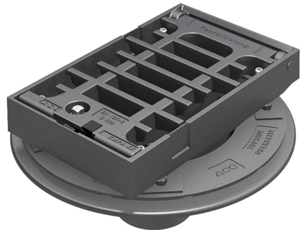
Brückenablauf Multitop Aqua Plus HSD-2, Klasse D 400, Abgang senkrecht, mit Flanschring verschraubt
