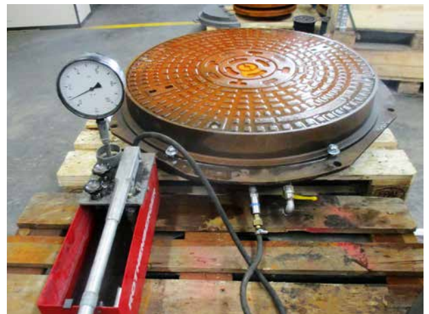
Rückstauprüfung an einer Komplettabdeckung
