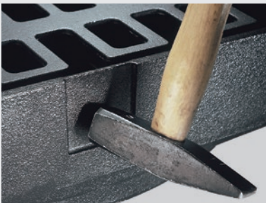
Umlaufender, geschlossener Gussrahmen für den Einsatz in Pflasterflächen mit vorgeformter, geschlossener Bauzeitentwässerung. Diese kann bei Bedarf geöffnet werden. Übliche Hilfsmittel wie Stopfen, Verschlussbleche usw. sind nicht erforderlich. Großer Einlaufquerschnitt der Bauzeitentwässerung, da sie nicht durch Roststäbe eingengt wird.
