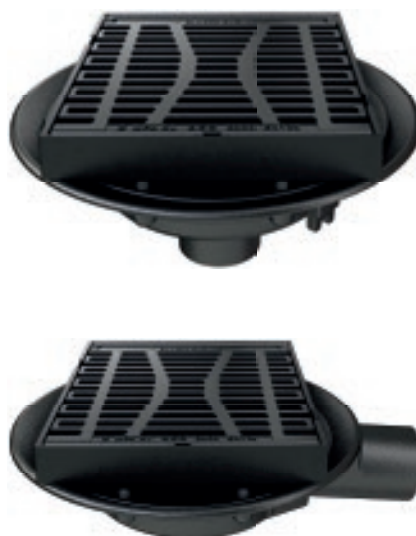
ACO Brückenablauf Multitop HSD-5 Kennmaß 500 x 500 aus Gusseisen Klasse D 400 nach DIN EN 124 Artikel entspricht der Richtzeichnung Was 1
