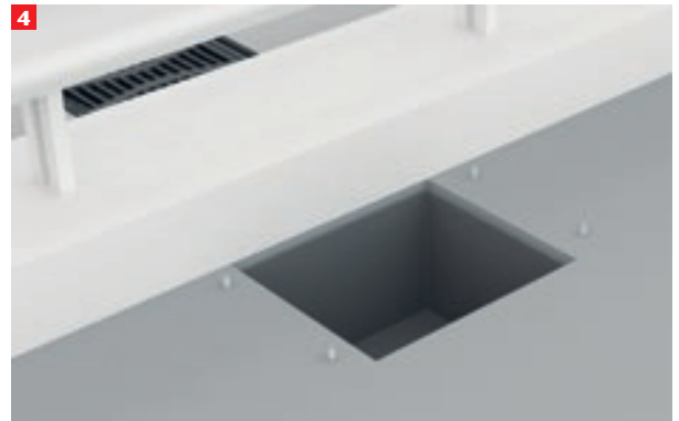
4 Freilegen des Unterteils in der Dichtbahn
